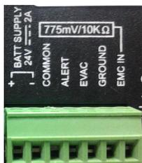
«Batt supply» клеммы аварийного питания DC 24V, 2A. При пропадании 220V матрица автоматически переключается в режим аварийного питания.
