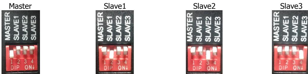
В режиме "Master" блок является основным и работает во всех режимах без ограничений. В режиме "Slave" работает как расширитель зон (max 32) с ограниченными возможностями. В этом случае блок поддерживает работу только удаленных пультов T-8000BW, входов Fire Alarm, Alert, Evac и EMC in.
