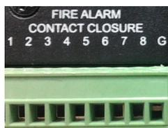
Сухие контакты пожарной сигнализации 1-8 зоны соответственно. При подаче сухого контакта на G + 1-8 срабатывает встроенная сигнализация, которая звучит в зоне соответствующей сухому контакту. Имеет приоритет перед всеми входами кроме EMC IN и MIC1 после нажатия кнопки EMERGENCY на передней панели. При исчезновения сигналов с EMC IN и MIC1 сигнализация продолжает работать. Так же после снятия сухого контакта матрица возвращается в исходное положение.
